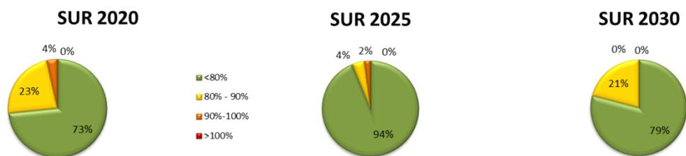
**Figura 14.** Porcentaje de transformadores (23 kV) según niveles de carga, Sistema Sur.
