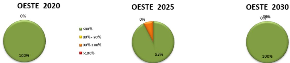
**Figura 17.** Porcentaje de transformadores (23 kV) según niveles de carga, Sistema Oeste.
