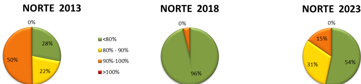
Figura 19. Porcentaje de transformadores (23 kV) según niveles de carga, Sistema Norte.
