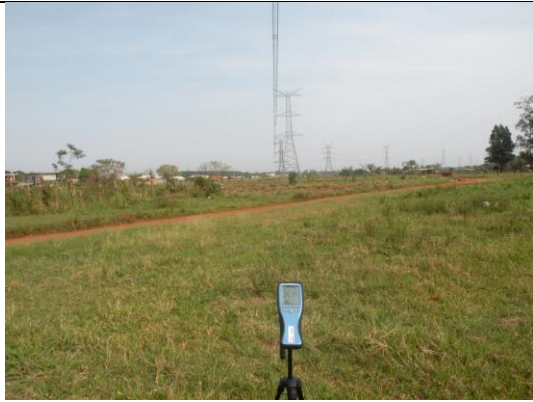
Foto 1. Medición de CEM – Línea de Transmisión de 500kV Itaipú – Villa Hayes
